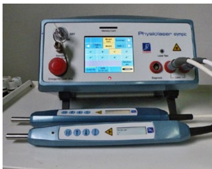
◀ Abb. 1: Laserpen 70 mW, 785 nm, cw Laser. Reimers & Janssen, Berlin
